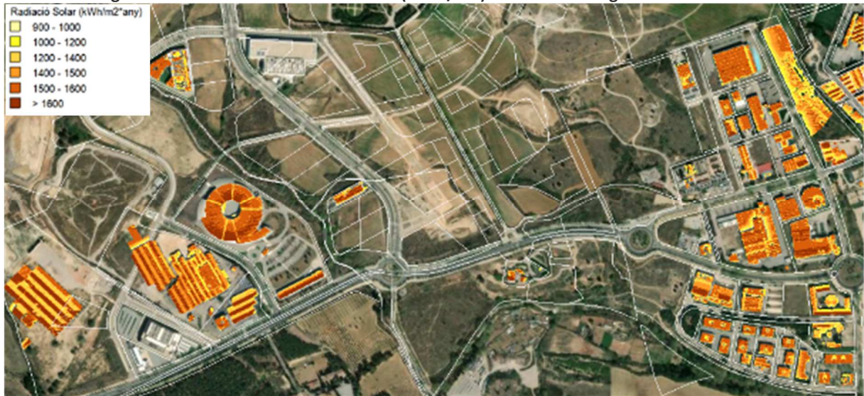
Figura 54 Producció solar FV estimada ( kWh/m2) al Parc Tecnològic i el Parc de l'Alba
